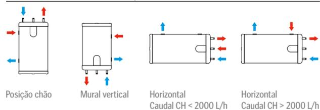
Graças à tecnologia tank in tank, os interacumuladores Smart oferecem uma superfície de troca elevada. Isto permite uma maior capacidade de produção de AQS, e reduz a necessidade de acumulação. Além disso, pode-se colocar tanto no chão, como na parede, seja na horizontal, seja na vertical.
