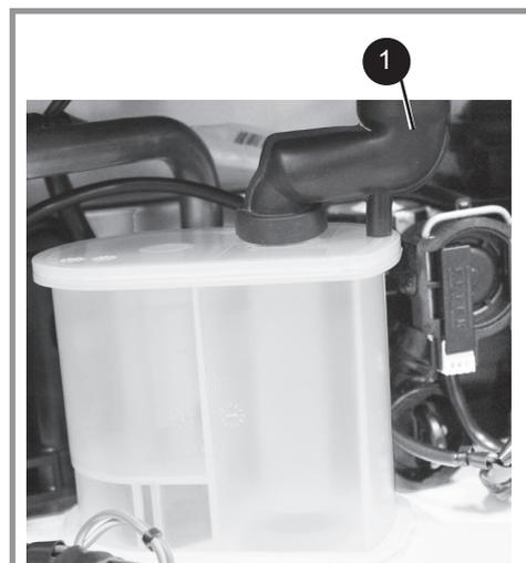
figura 46 - Tubo de goma de desagüe del colector
